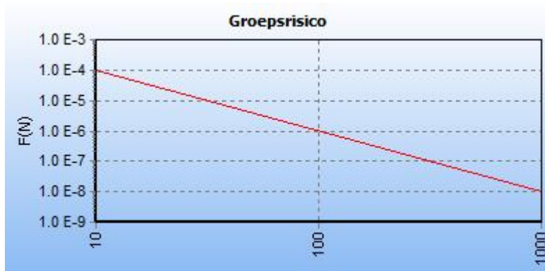
Afbeelding 6 fN-curve buisleiding Z-506-01-deel-1, huidige situatie
