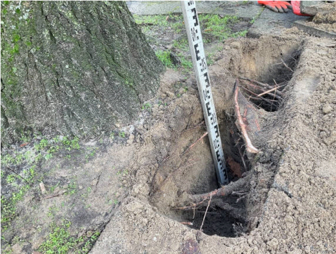
Foto 7: Beeld van intensieve beworteling onder de stoep van de zomereik met boomnummer 22 aan de Karel Doormanlaan.
