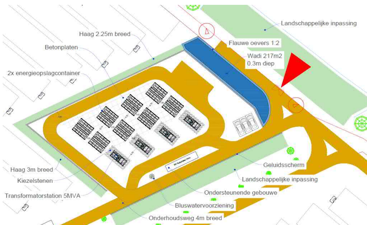
Figuur 23: Ontwerp EOS opstelling met locatie bluswatervoorziening en onderlinge afstanden
