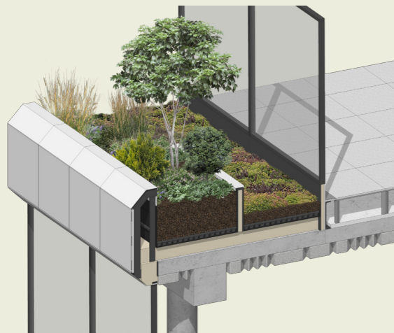
Systeemvloer Bij maximale belasting vloer | 400 kg/2 Veranderlijke belasting beloopbaarheid | 100 kg/m 2 Beplanting Sedum/kruiddachtige beplanting | 300 kg /m 2 | 150mm substraat en 100mm kratten Vaste planten | 1050kg/m 2 | 600mm substraat en 100mm kratten
