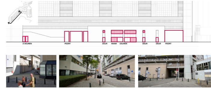
ANALYSE VAN DE GEVEL LANGS DE RIJSTUIN De gevel aan de straat "Rijstuin" bevat twee poorten die de verbinding leggen met de Mariniersweg. Daarnaast zijn er verschillende deuren en ramen waar rekening mee gehouden moet worden.
