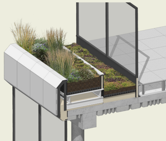
Systeemvloer Bij maximale belasting vloer | 400 kg/2 Veranderlijke belasting beloopbaarheid | 100 kg/m 2 Beplanting Sedum/kruiddachtige beplanting | 300 kg /m 2 | 150mm substraat en 100mm kratten Vaste planten | 700kg/m 2 | 400mm substraat en 100mm kratten
