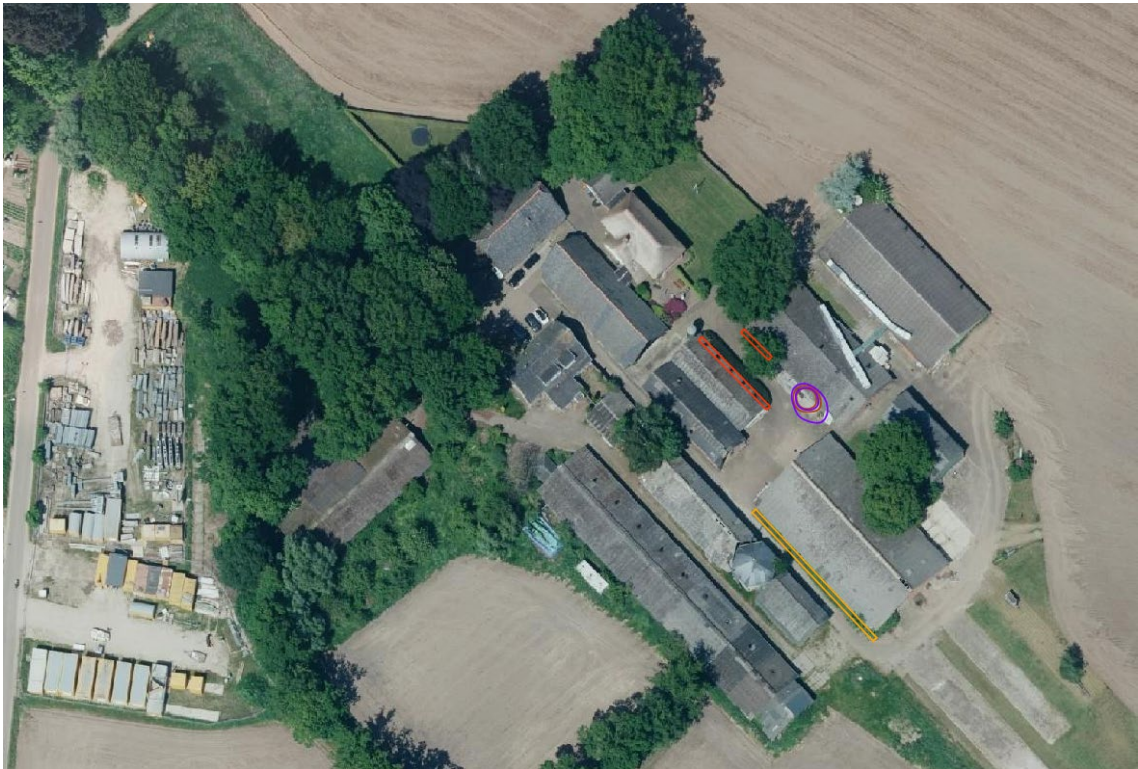
Afbeelding 2: Te onderzoeken druppelzones (rood en oranje) en minerale olie verontreiniging (paars) op PFAS
