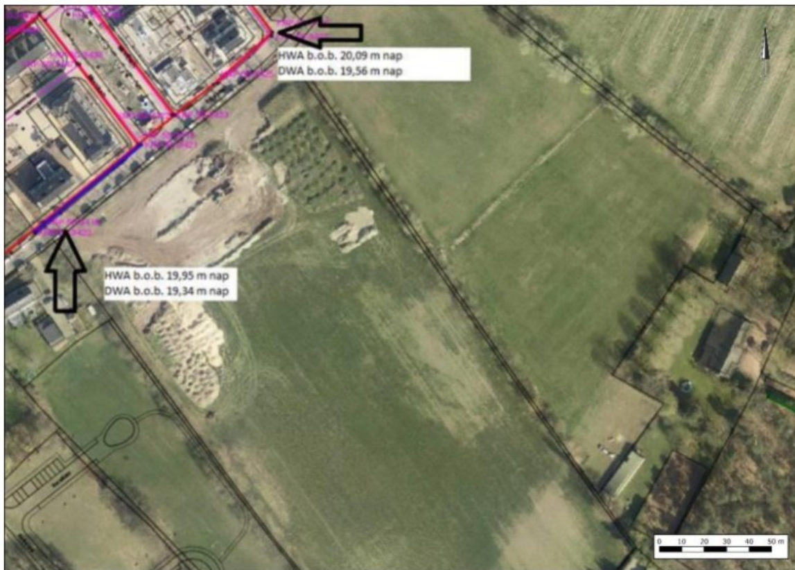
Figuur 4.4 Situering riolering (bron: Kragten, memo uitgangspunten ontwerp)
