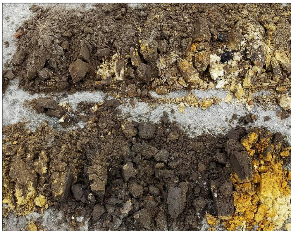
Figuur 8. Het boorprofiel van boring 3. De leesrichting is van links naar rechts en van boven naar onder.
