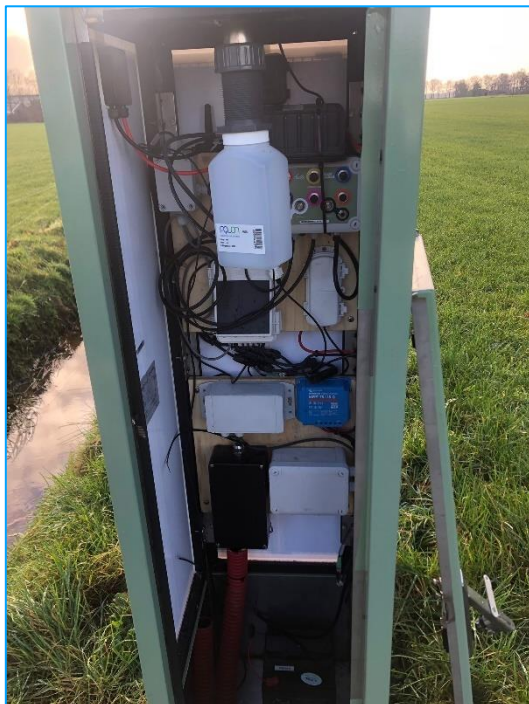
Figuur 2-6: binnenzijde van het geplaatste klimaatstation met voorziening voor opvangen van regenwater om te analyseren in het lab
