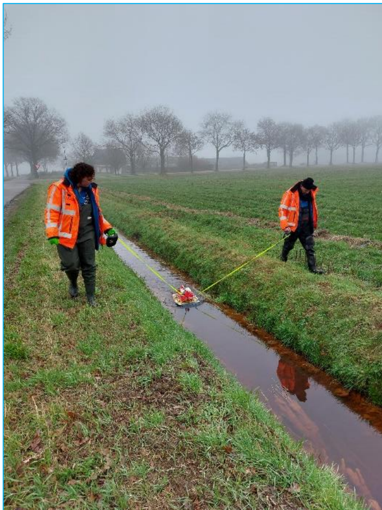
Figuur 5-16: uitvoering van de routing met sensoren en gps logger in het stroomgebied van de Vinkenloop (januari 2023).
