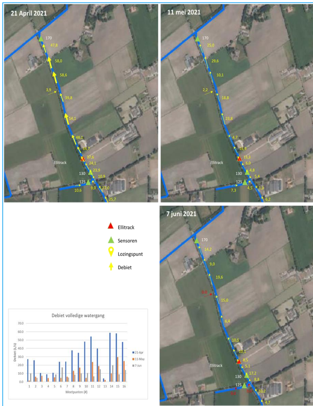
Figuur 8-1 Debieten in het stroomgebied van De Vinkenloop berekend aan de hand van gemeten stroomsnelheden. De metingen zijn in 3 verschillende maanden uitgevoerd. Niet alle zijsloten zijn in het onderzoek meegenomen.
