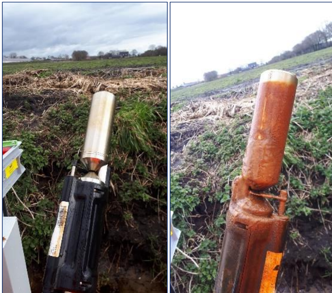
Figuur 4-1: nitraat sensor in de Vinkenloop na het schoonmaken en één week later
