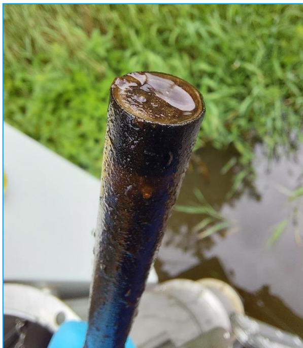
Figuur 2-5: de ammonium ISE sensor met biofouling en sediment op het membraan. (foto: N. van Aarle, Aquon)
