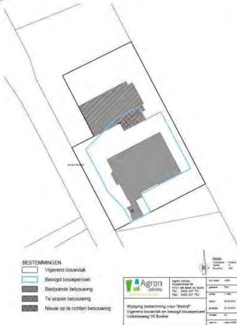
Figuur 43 Te slopen en saneren onderdelen
