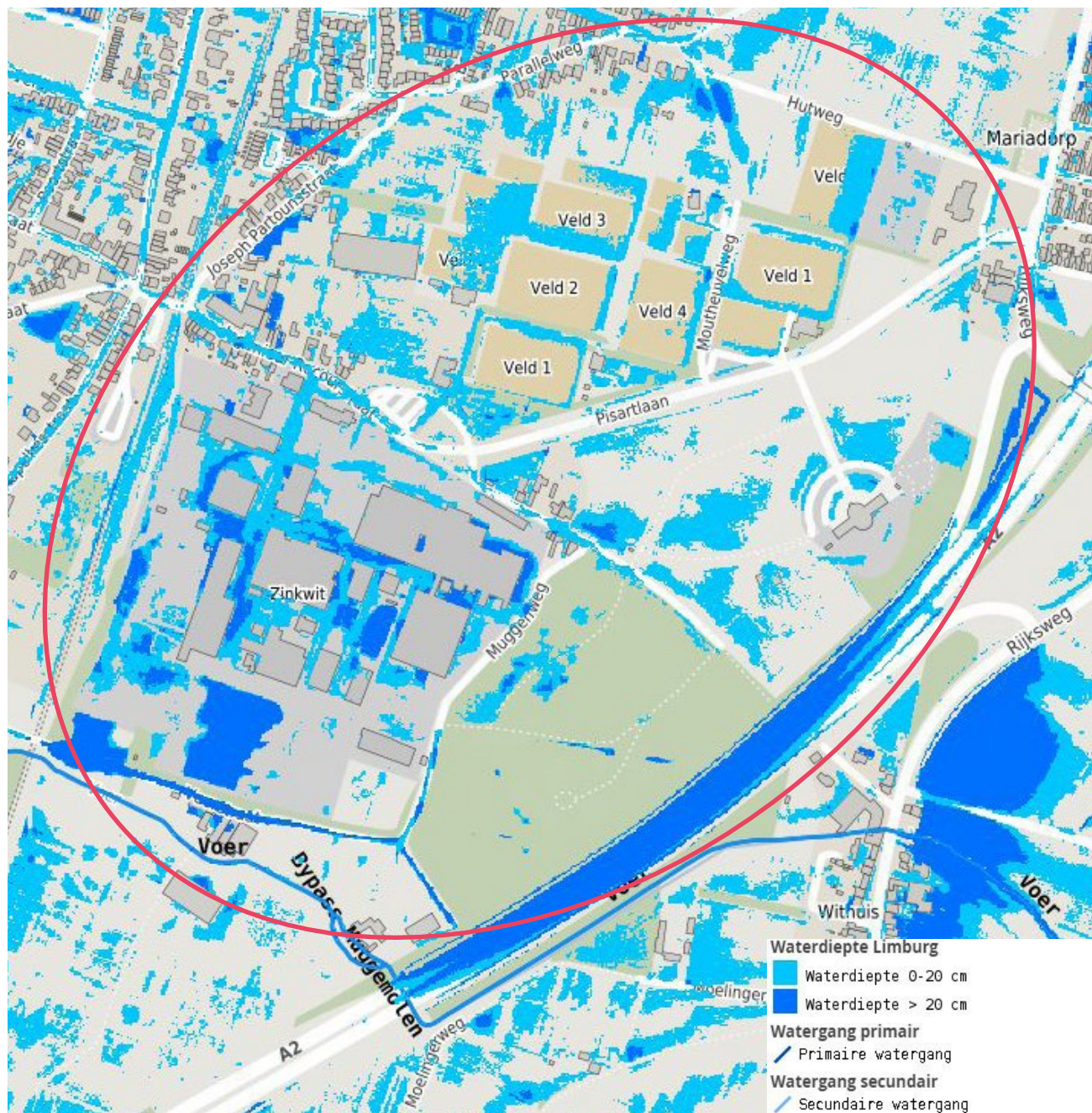
Figuur 9: Waterdiepte op straat na een extreme bui en watergangen
