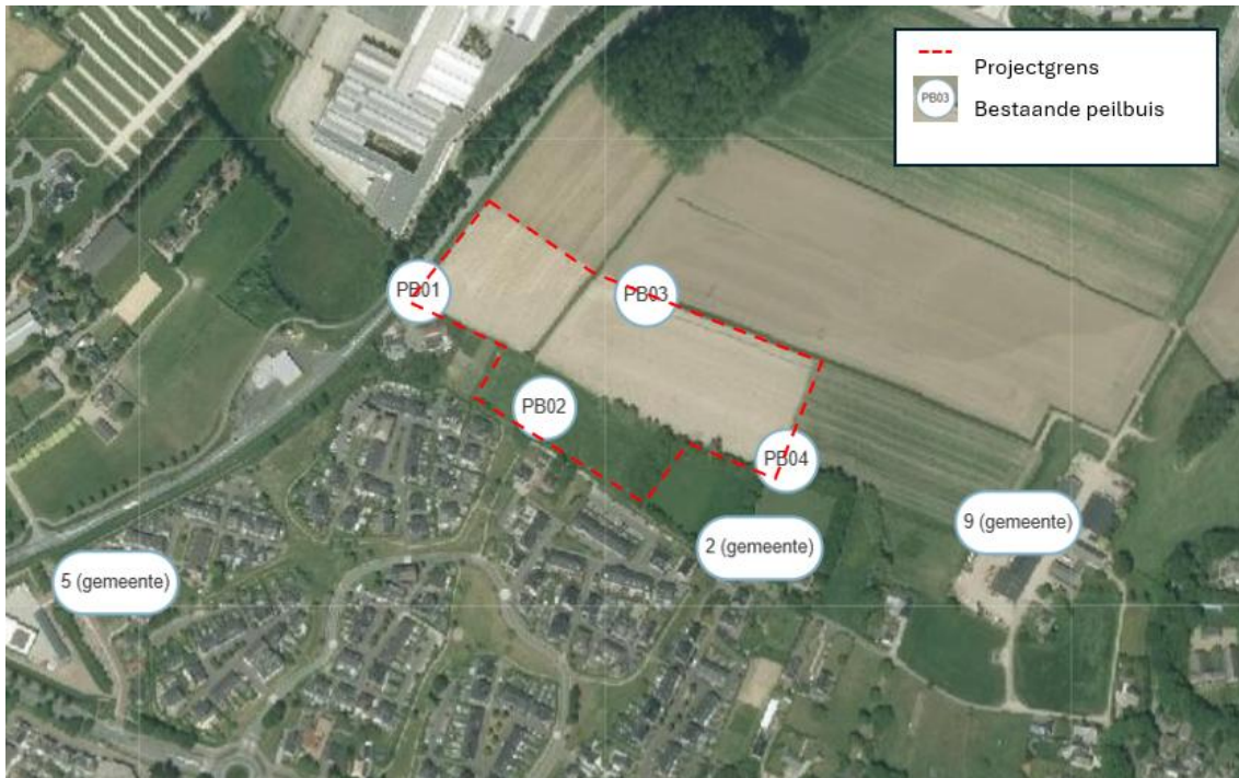
Figuur 3: Op dit moment wordt er in zeven peilbuizen in het gebied gemeten met telemetrische meetapparatuur (uurlijkse meting, dagelijks geactualiseerd). Peilbuis 5 (gemeente) aan de Robert Josephstraat wordt al meer dan 30 jaar bemeten, dit is een waardevol referentiepunt.
