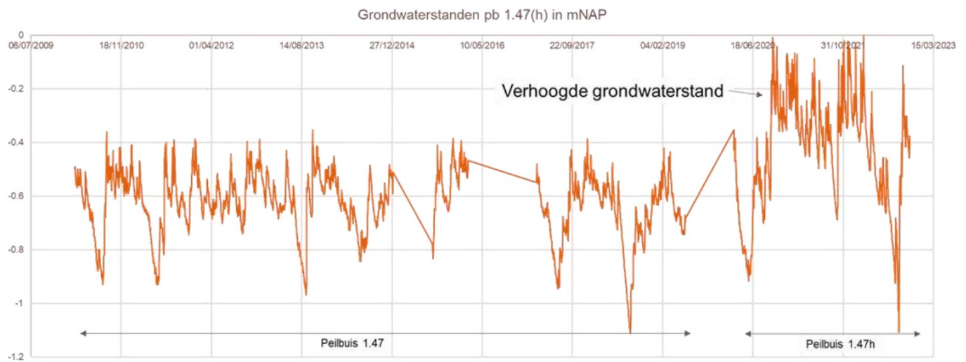
Figuur 26: Peilbuis pb1.47 en vervangend peilbuis pb1.47h van de gemeente Rijswijk aan de Van Hardenbroeklaan.
