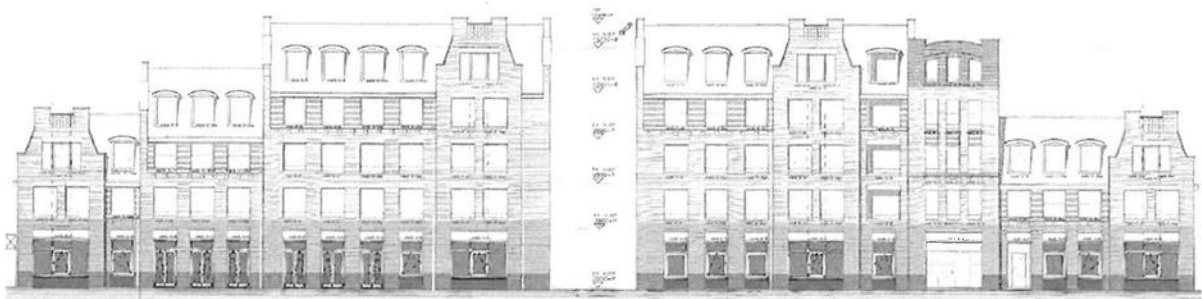
Transformatie van commerciële plint in complex Brederode naar 10 appartementen.
