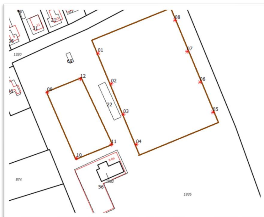
Figuur 3: Positie van de 12 lichtmasten met armaturen
