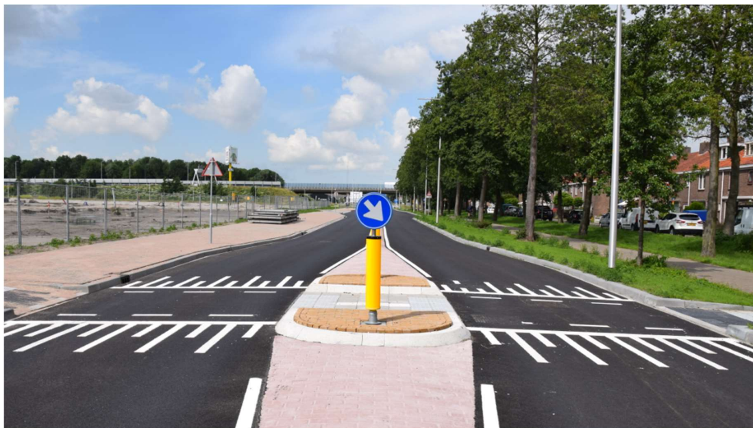
Afbeelding 8: Principe inpassing middengeleider voetgangersoversteekplaats
