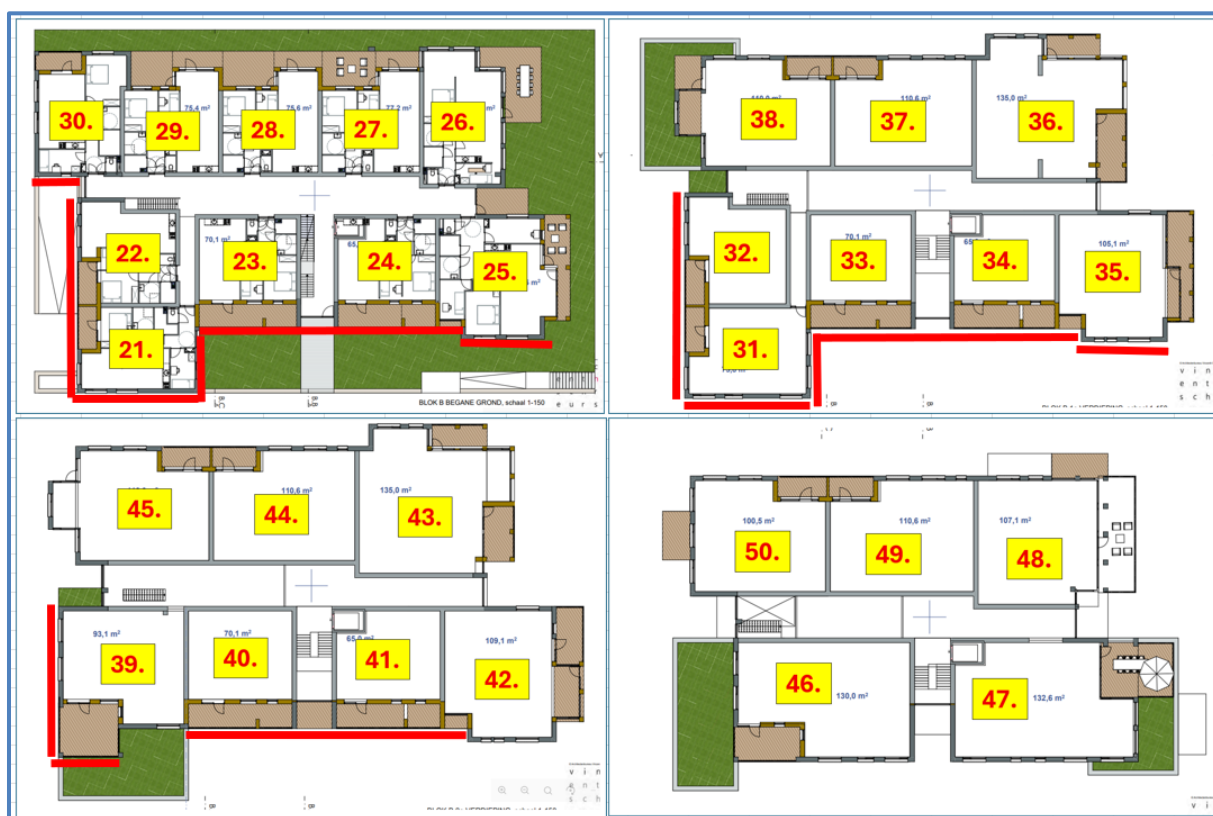
Afbeelding 8. Gevels met een overschrijding van de standaardwaarde (per bouwlaag)
