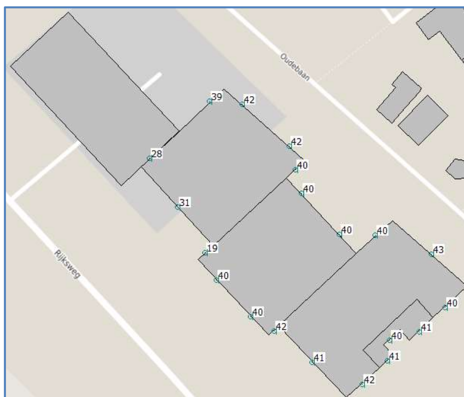
Afbeelding 7.3 Geluid L_{den} Gemeentewegen Berekend geluid op een hoogte van 8,0 meter
