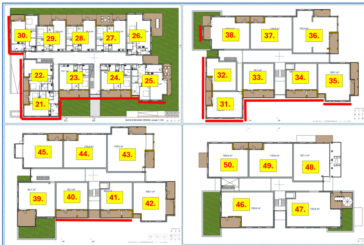
Afbeelding 9. Gevels met een overschrijding van de standaardwaarde
