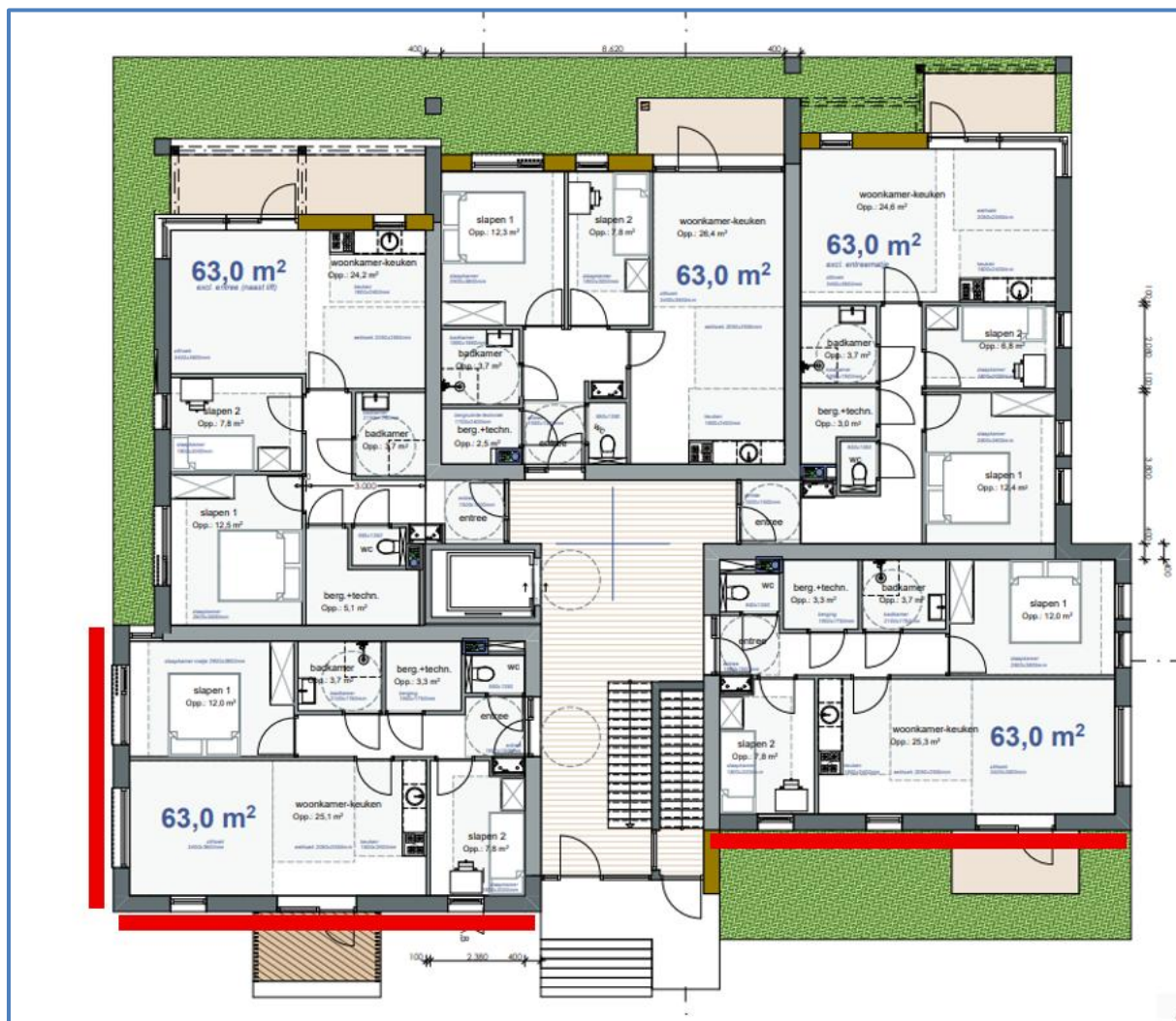
Afbeelding 6. Gevels met een overschrijding van de standaardwaarde (alle bouwlagen)
