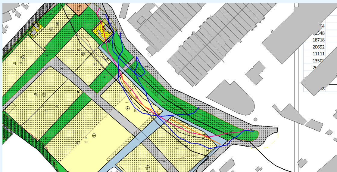
figuur 3: ligging 55 dB(A)-etmaalwaarde cumulatief (paars), 50 dB(A) per bedrijf (blauw) en 60 dB(A) maximale geluidsniveau in de nacht (oranje). Rekenhoogte 16 meter (gestapelde bouw).
