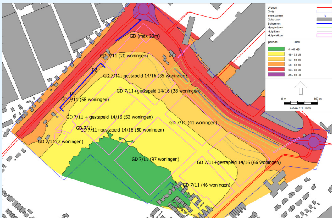
figuur 3: geluidsbelasting wegverkeer op 13.5 meter (gecumuleerd, zonder aftrek art. 110g Wgh)
