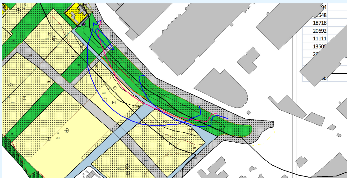
figuur 7: ligging 55 dB(A)-etmaalwaarde cumulatief (paars), 50 dB(A) per bedrijf (blauw) en 60 dB(A) maximale geluidsniveau in de nacht (oranje). Rekenhoogte 6 meter (2 bouwlagen).
