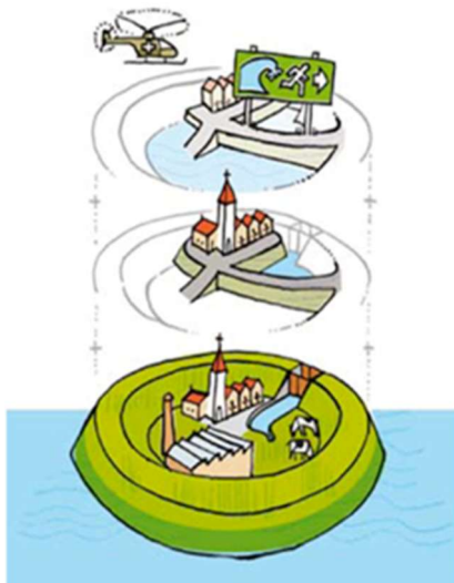
Figuur 13 Meerlaagse veiligheid. Laag 1 is preventie (oa dijken), laag 2 is de ruimtelijke inrichting en laag 3 is de rampenbeheersing (oa evacuatieplannen).
