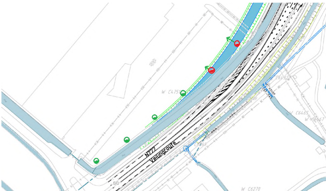
Figuur 5-32: Verplaatsing putten langs N222
