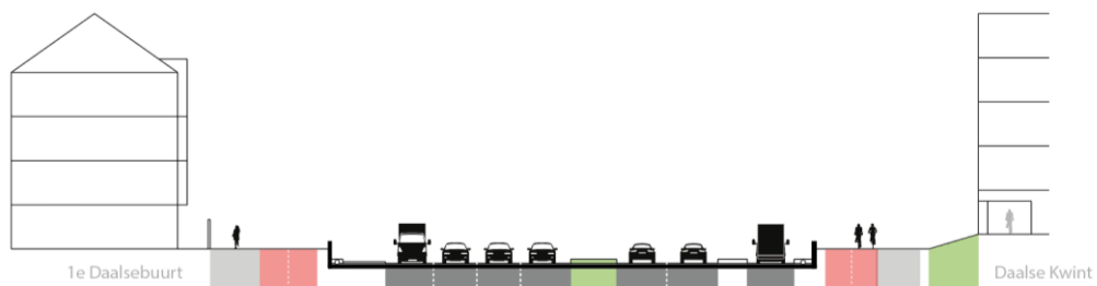
Principedoorsnede wegprofiel en tunnelbak met keermuren
