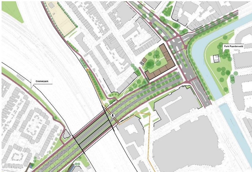
Scenario 2: Optimalisatie en versmalling met 2x2 wegprofiel
