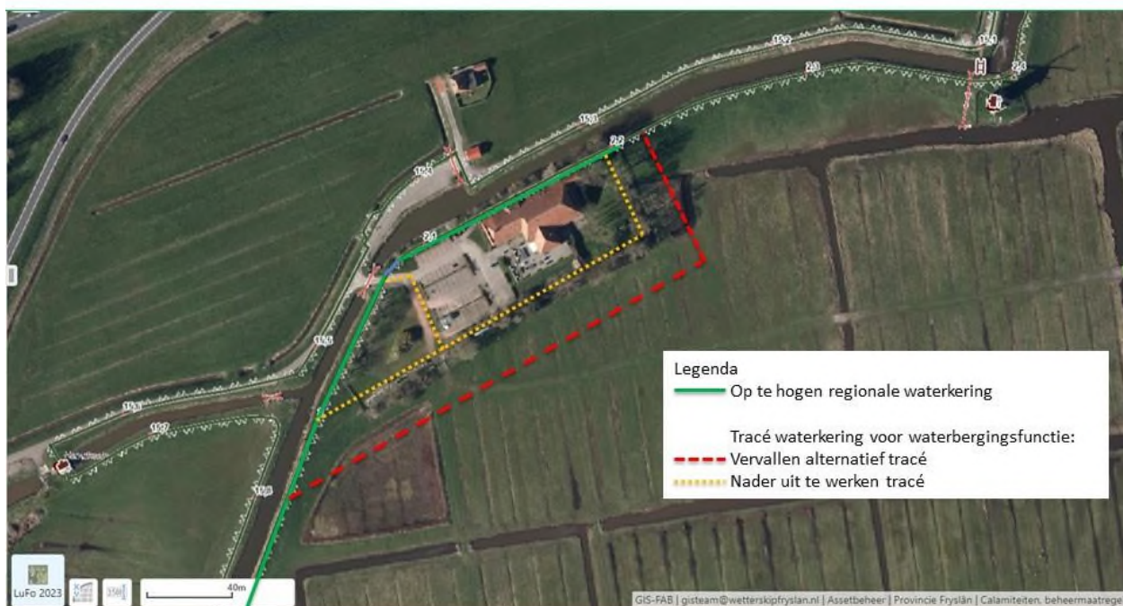
Figuur 3-4 Detailoverzicht kering bij erf. In het rood het tracé dat komt te vervallen en in het geel de geïntegreerde kering met het erf. Het definitieve ontwerp wordt nog nader uitgewerkt.
