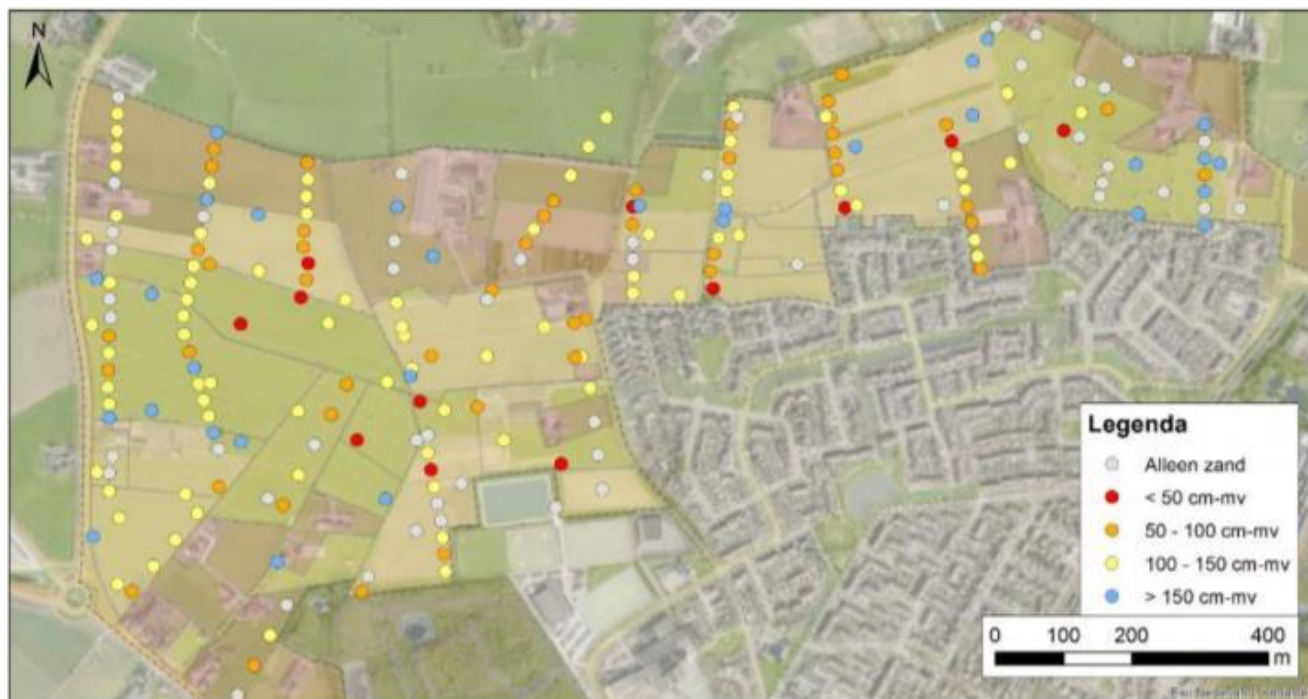
Afbeelding 4: Diepte van de bovenste leem, klei of veenlaag in boringen met een einddiepte van minstens 1.50 m-mv
