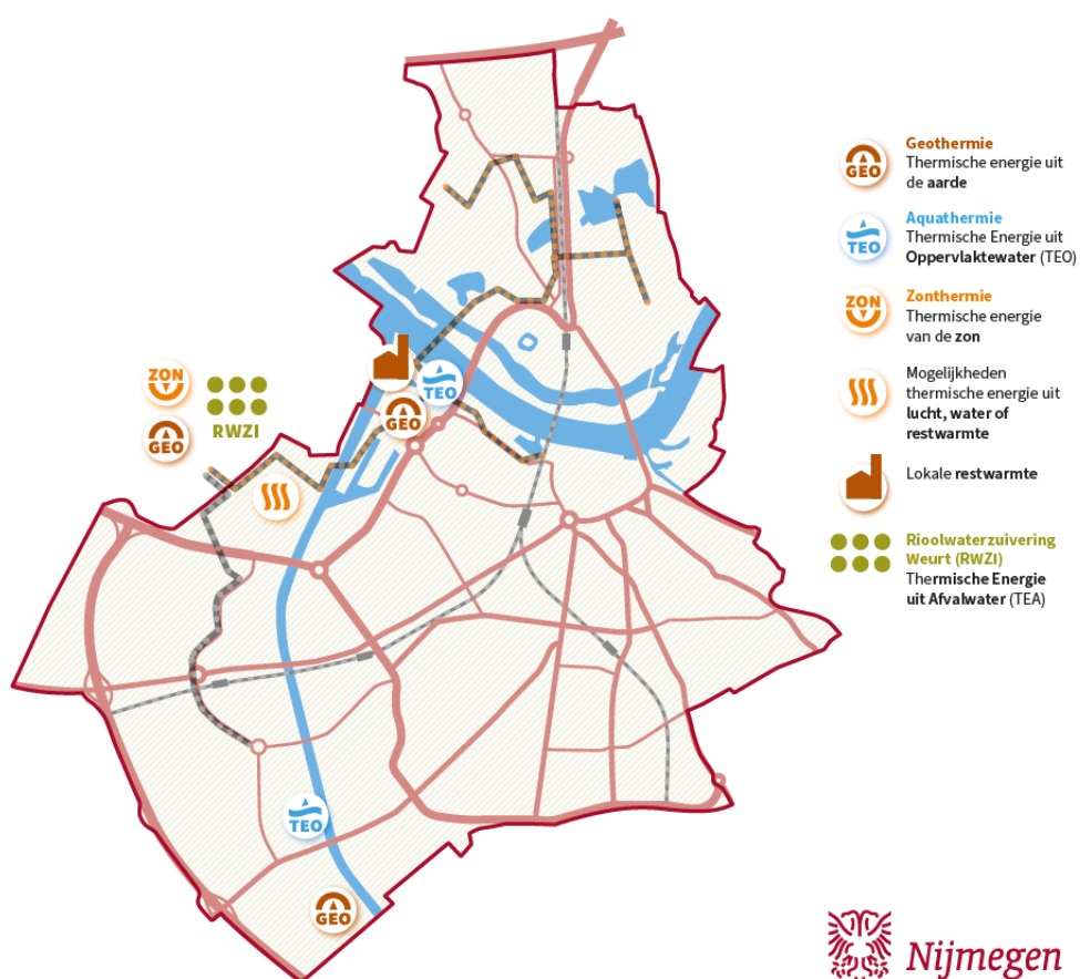
Figuur 7 - illustratie van een eindsituatie waarbij warmte wordt geleverd aan de Nijmeegse warmtenetten, zonder gebruik te maken van warmte uit afvalverbranding.
