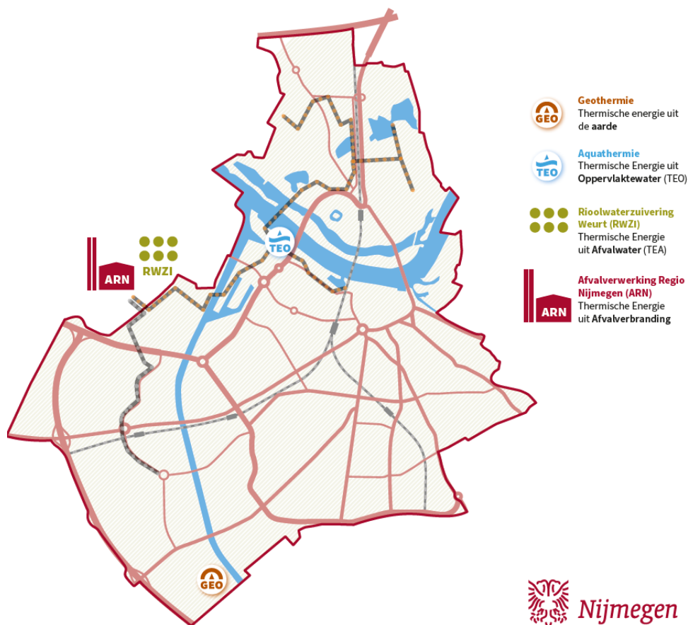
Figuur 6 – illustratie van een eindsituatie waarbij warmte wordt geleverd aan de Nijmeegse warmtenetten, gebruik makend van warmte uit afvalverbranding.
