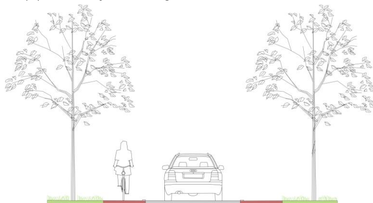
Figuur 5.4 Principeprofiel oostelijk deel Oostingslaan
