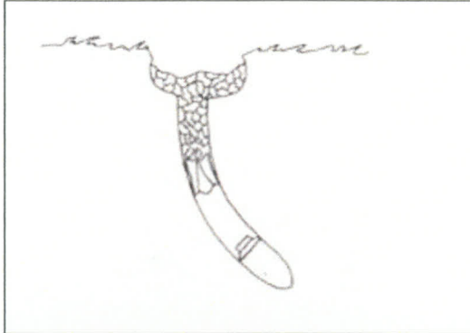
Figuur 5: Doorsnede van een inslagopening van blindganger vliegtuigbom.
