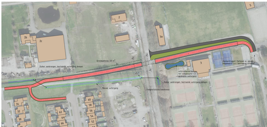
Afbeelding 9 Schetsvoorstel fietstunnel Waterval, helling 3%
