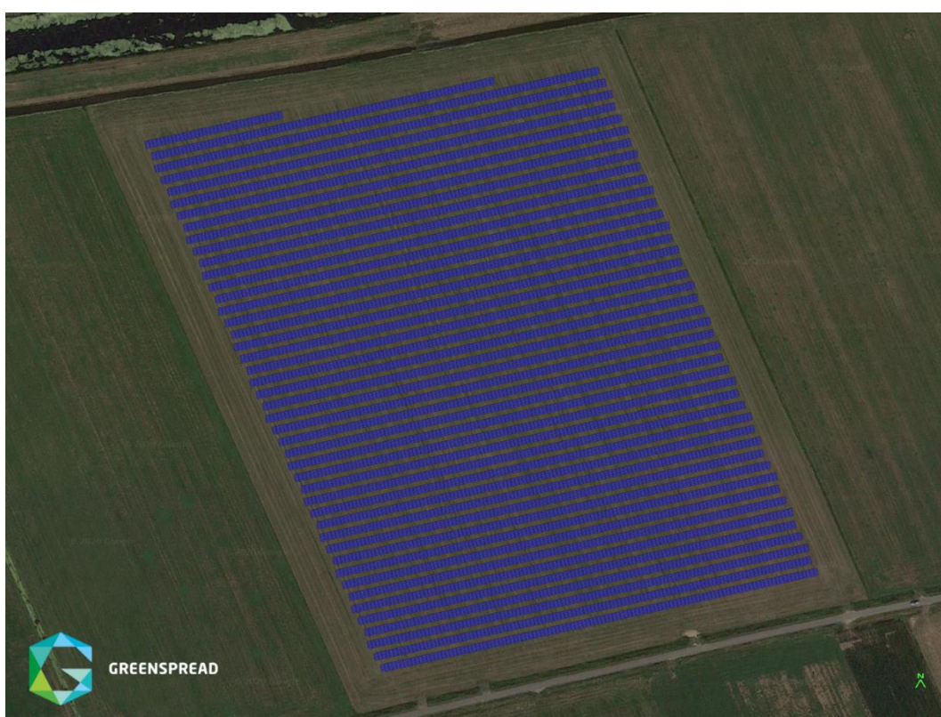
Figuur 2: Het systeemontwerp met 20.472 panelen.
