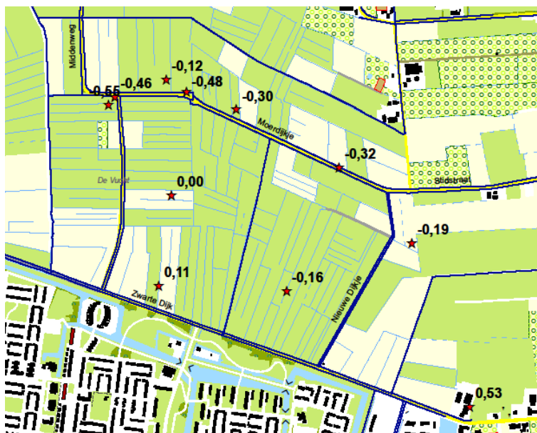
Figuur 3.9 Kaart met Gemiddelde Voorjaar Grondwaterstand (GVG) gemeten in de meetpunten (GVG in m+NAP) (bron Dinoloket)
