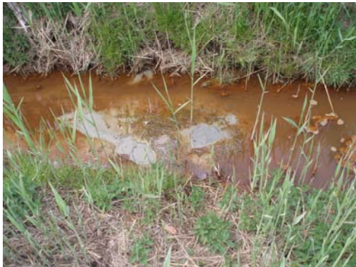
Figuur 3.1 Kwel in sloot.
