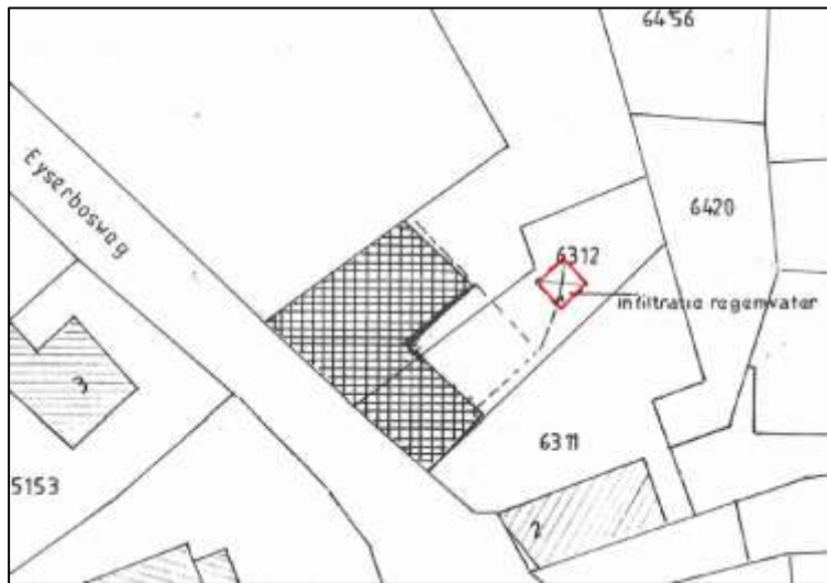
Beoogde ligging infiltratievoorziening
