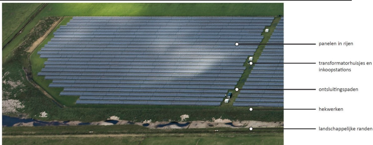
Figuur 64 Elementen van een zonnepark.
