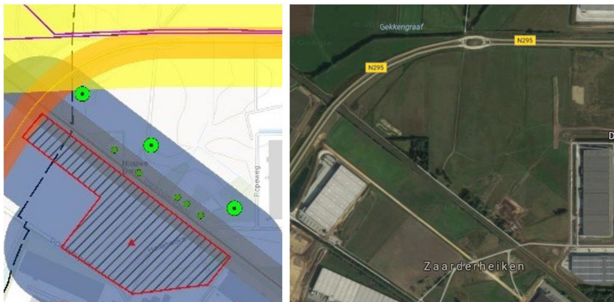
Figuur 15 Links: uitsnede belemmeringenkaart met ligging van WT-01, WT-02 en WT-03 (groen) binnen de voorkeursafstand (blauw) van de railterminal (rood omkaderd); rechts: hetzelfde gebied, luchtfoto.
