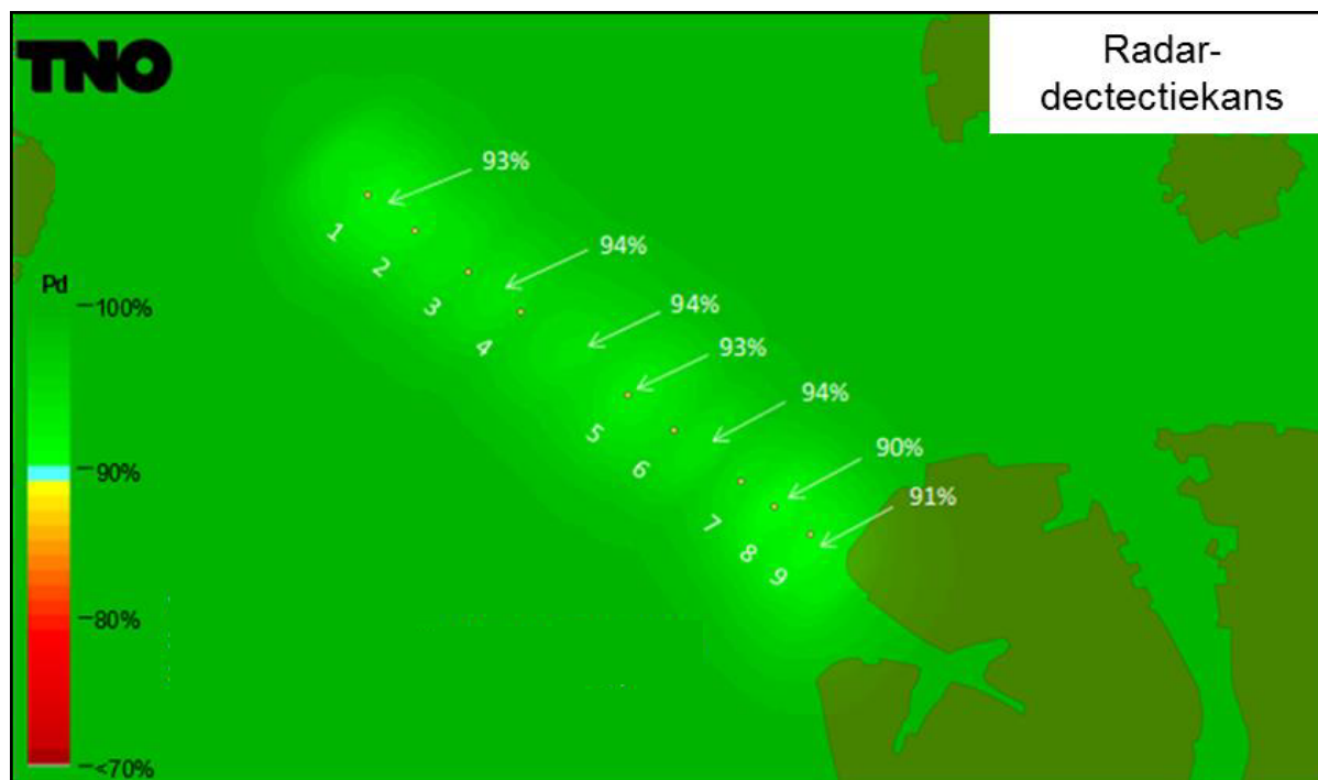
Figuur 19: Uitkomsten berekening van de radardetectiekans
