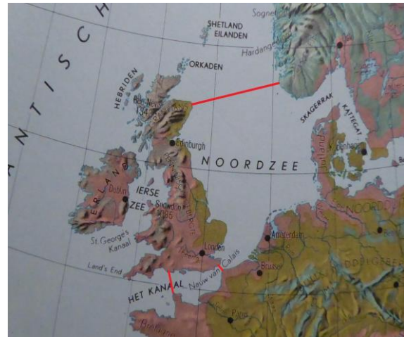
De Noordzee als binnenzee. In rood de afsluitingen. Het Kanaal als megaschutsluis met water-energiecentrales.
