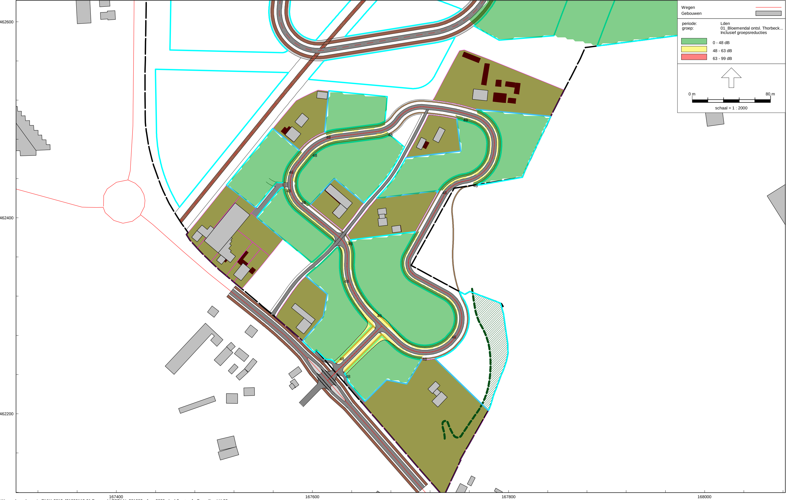
Vlekkenplan Bloemendal in Barneveld Geluidcontouren tgv ontsluitingsweg Thorbeckelaan, na aftrek 5 dB ex. art. 110g Wgh - h=4,5m+mv
