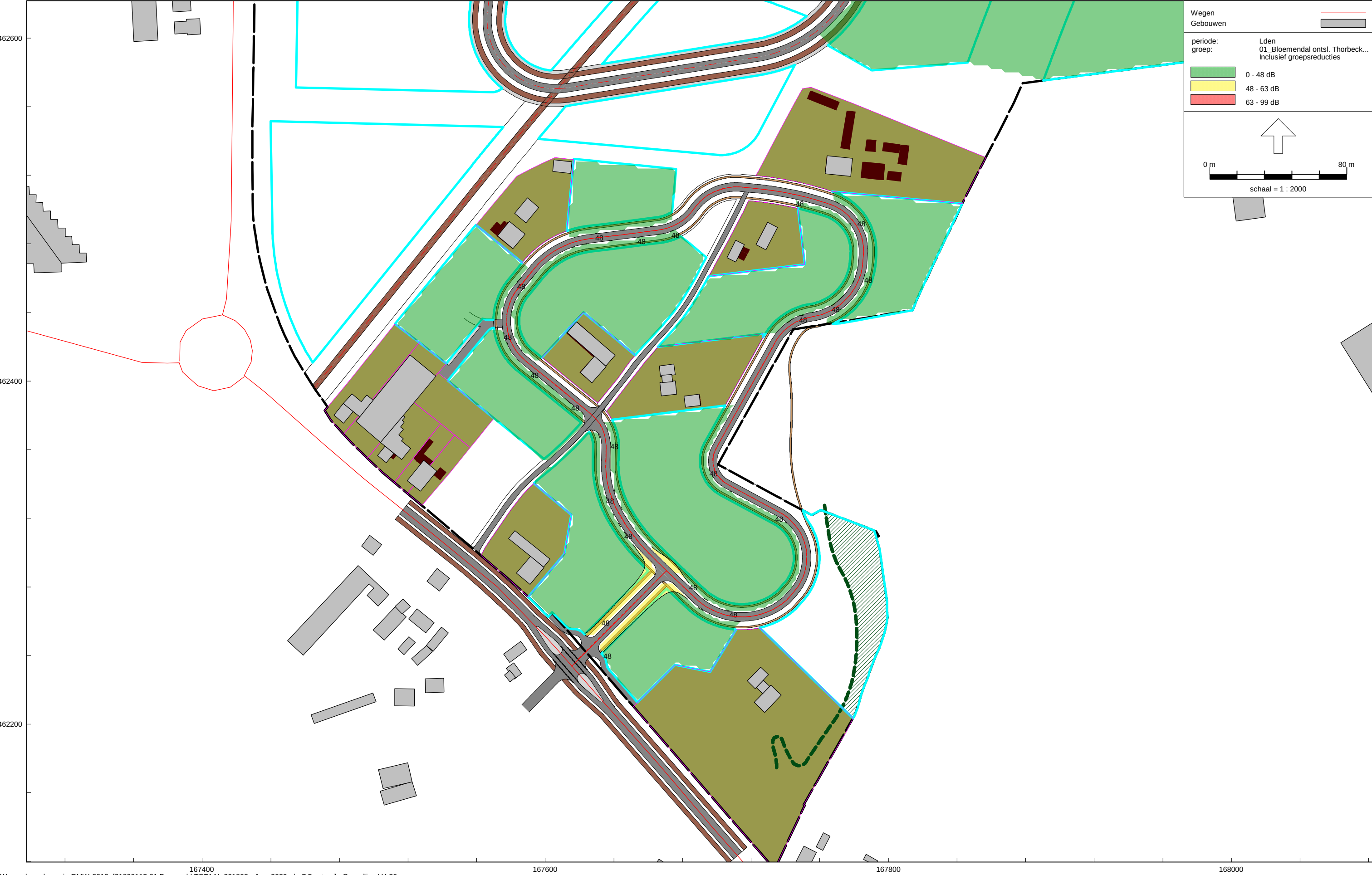
Vlekkenplan Bloemendal in Barneveld Geluidcontouren tgv ontsluitingsweg Thorbeckelaan, na aftrek 5 dB ex. art. 110g Wgh - h=7,5m+mv
