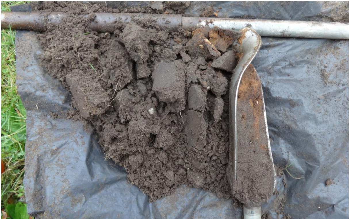
Boring 9: Boorkernen 0 – 40 cm –Mv. Overgang van een oud bouwlanddek naar B-horizont in verspoelde pleistocene afzettingen.
