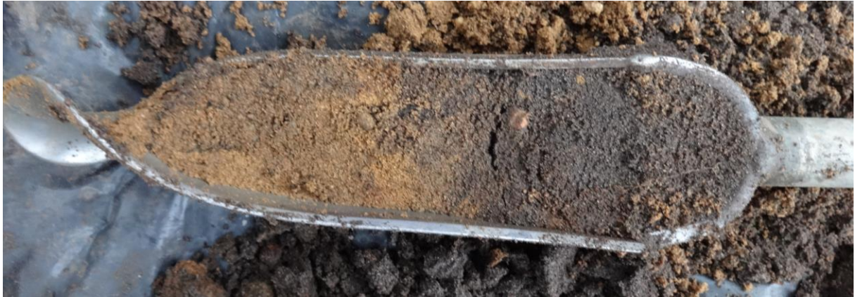
Boring 12: Overgang bouwvoor (Ap) naar verspoelde pleistocene afzettingen (BC).
