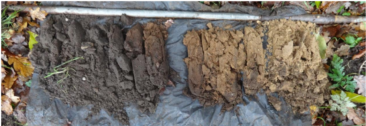
Boring 5: Totaaloverzicht boorkernen.
