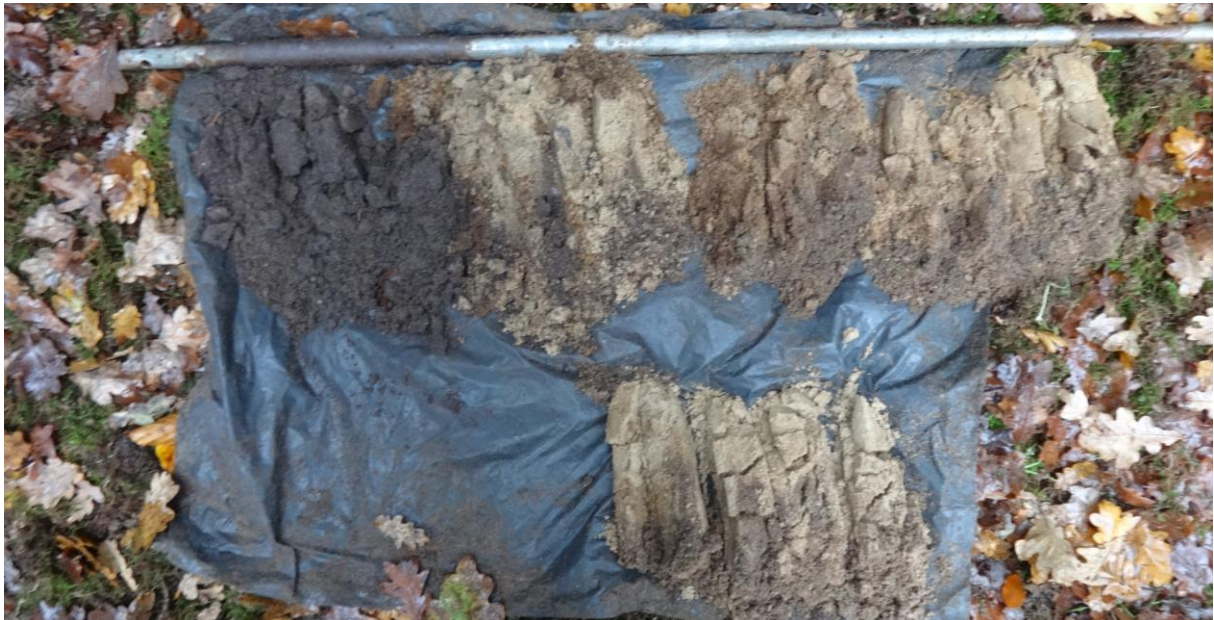
Boring 3: Totaaloverzicht boorkernen.
