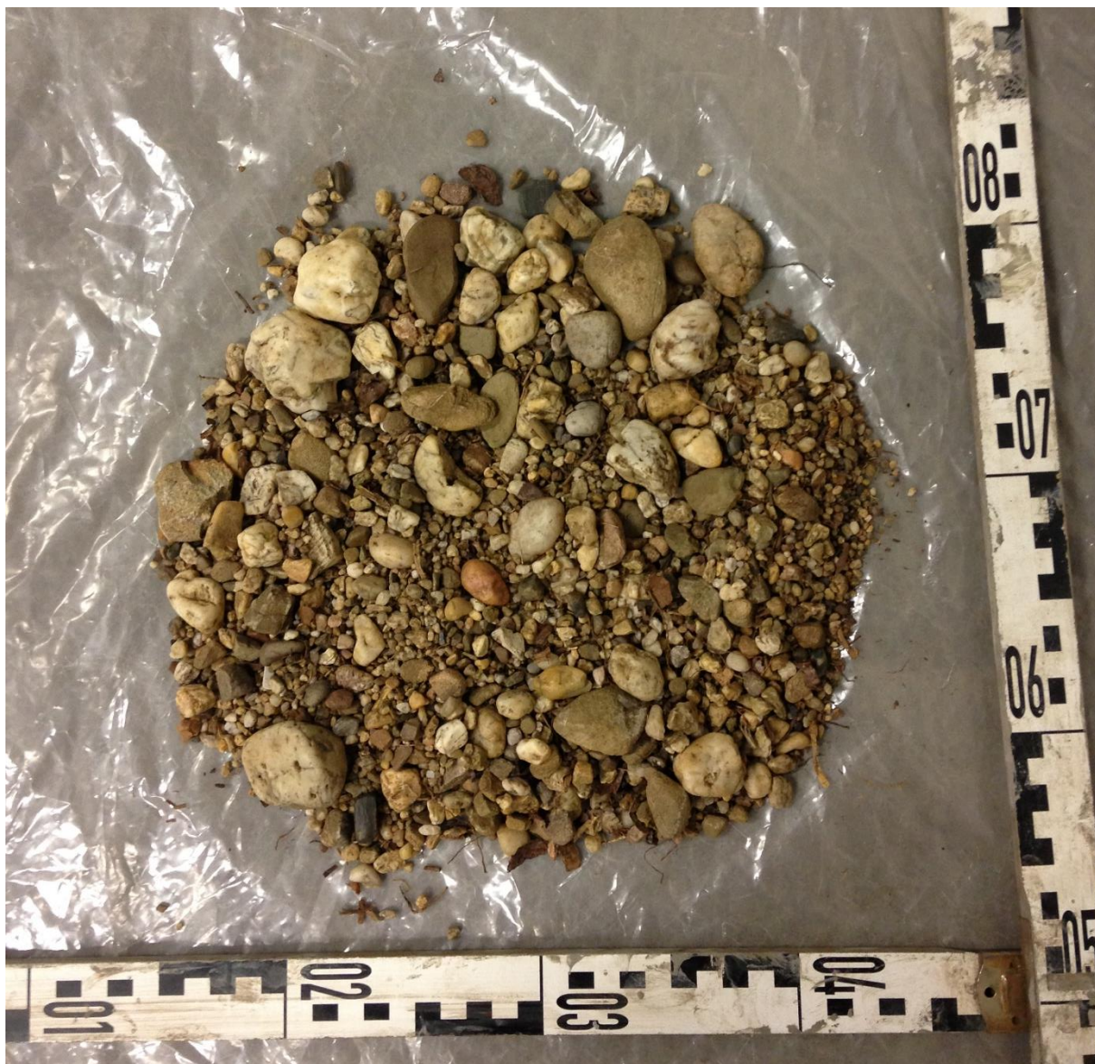
Figuur 3: voorbeeld van een zeefresidu
