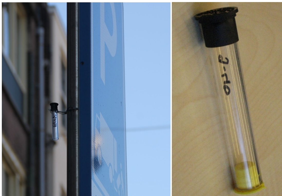
Foto 1 en 2. Palmes buisjes voor het meten van stikstofdioxide.
