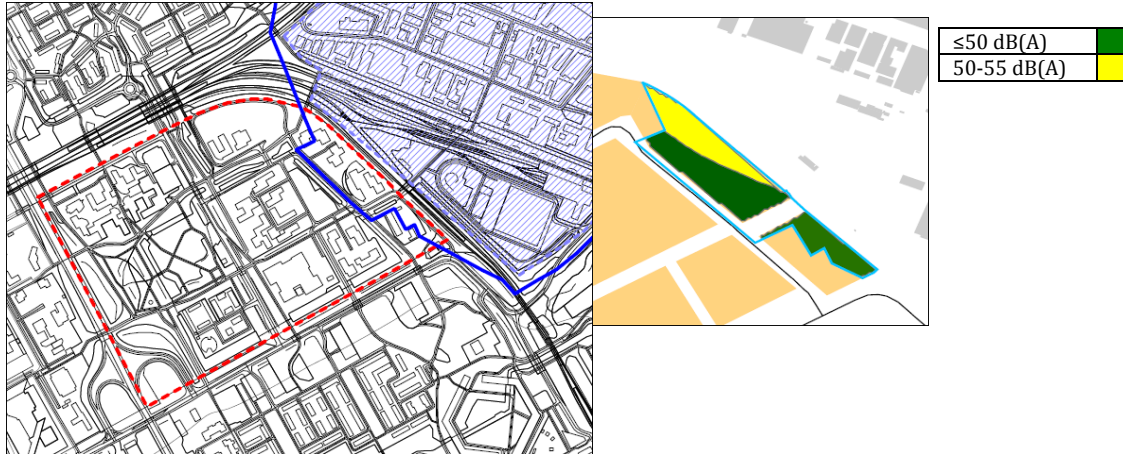
Afbeelding 3.3G Geluidszonering en geluidsbelasting bedrijventerreinen Diemen
