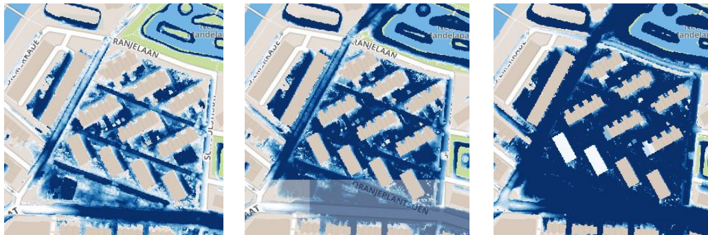
Figuur 2.1 Het Oranjeplantsoen bij een bui van 60, 90 en 120 mm in een uur (Klimaatatlas AGV, https://agv.klimaatatlas.net/ )
