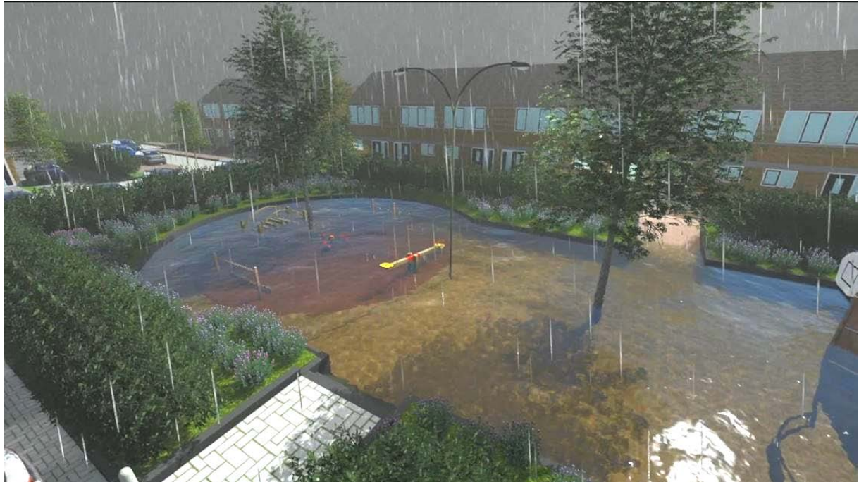
Figuur 2.2 Ontwerp van een verdiept aangelegde speelplaats waar hemelwater geborgen wordt (Vlindertuin, minor HvA)
