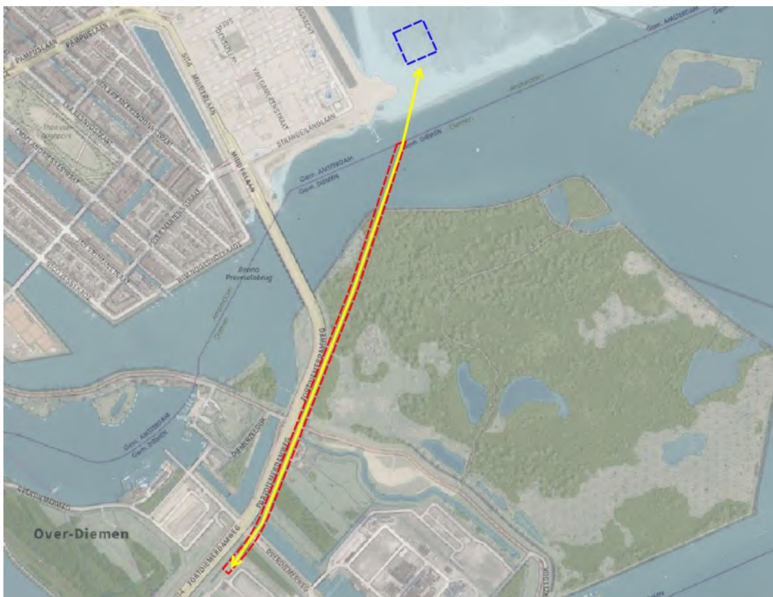
afbeelding 1: de gele lijn geeft de nieuwe verbinding aan, met rode stippellijn is de grens van het nieuwe bestemmingsplan aangeduid en met blauwe stippellijn ongeveer de locatie van het nieuwe transformatorstation op IJburg Strandeiland (bron: Qirion)
