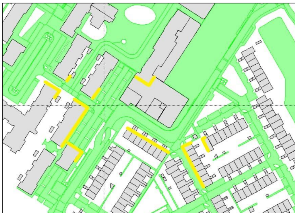
Figuur 6 Grafisch overzicht van de overschrijdingen (in geel) van de richtwaarde/grenswaarde 60 dB(A) (nachtperiode)
