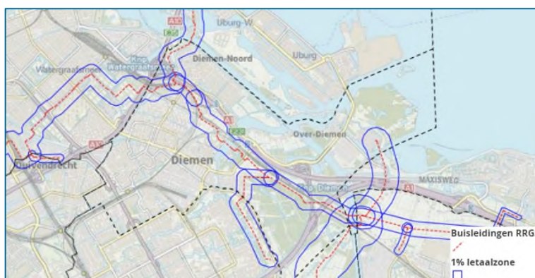
Figuur 11-16: Buisleidingen (Bron: EV Signaleringskaart).
