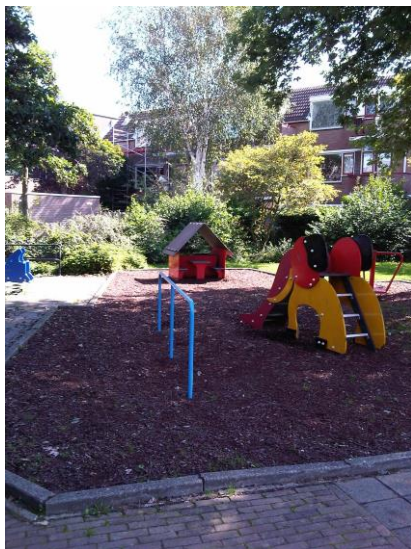
Afbeelding 4.3.2.1 Voorbeeld: op de speelplek aan de Bestevaer is de ondergrond van boomschors vervangen voor Dekowood. De opsluitbanden zijn daarbij verwijderd. Er is geen harde overgang meer tussen gazon en valdempend materiaal.
