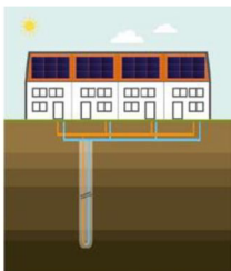
Mini-warmtenet voorbeeld (Bron: Itho Daalderop)
