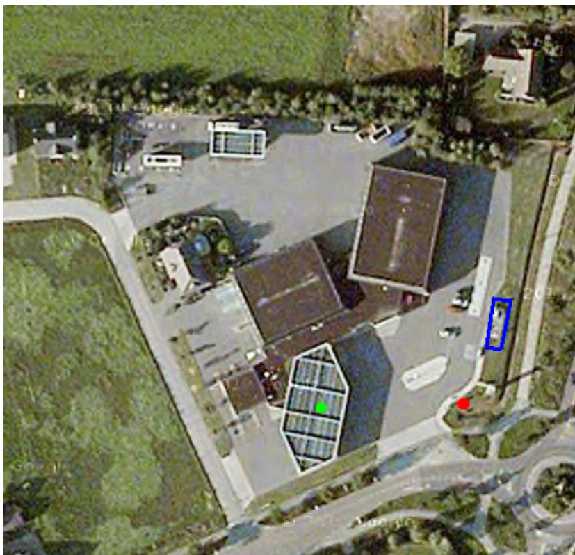
Figuur 3.2 Tankstation met vulpunt LPG (rood), ondergrondse LPG-tank (blauw), LPG-afgiftepunt (groen)
