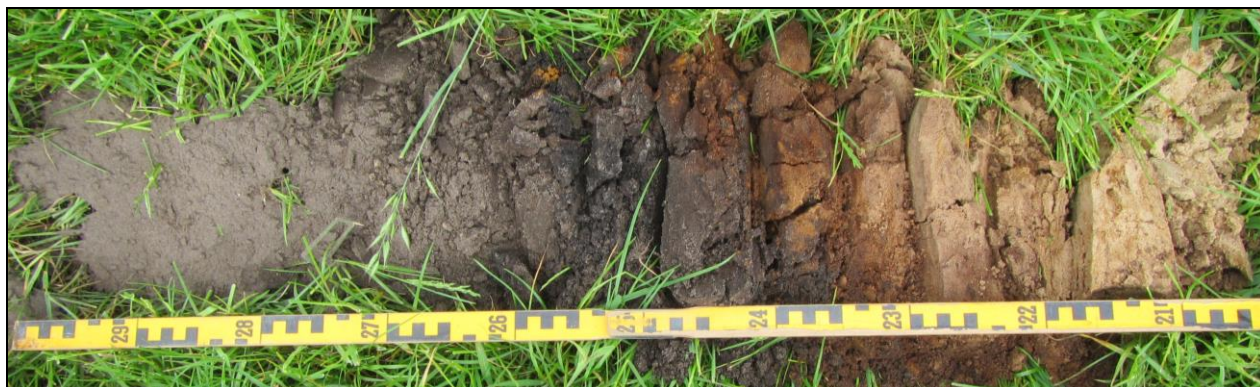
Figuur 6: Zicht op boring 4. De B-horizont is geroerd, want is gemengd met materiaal uit de C-horizont.
