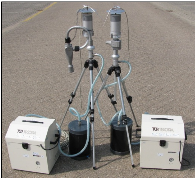
De complete opstelling voor bemonstering van PM10 (links) en PM2,5 (rechts). Van boven naar beneden bestaat de opstelling uit: inlaatkop met temperatuurvoeler, cycloon, filterhouder, slang, condensatievat en pomp
