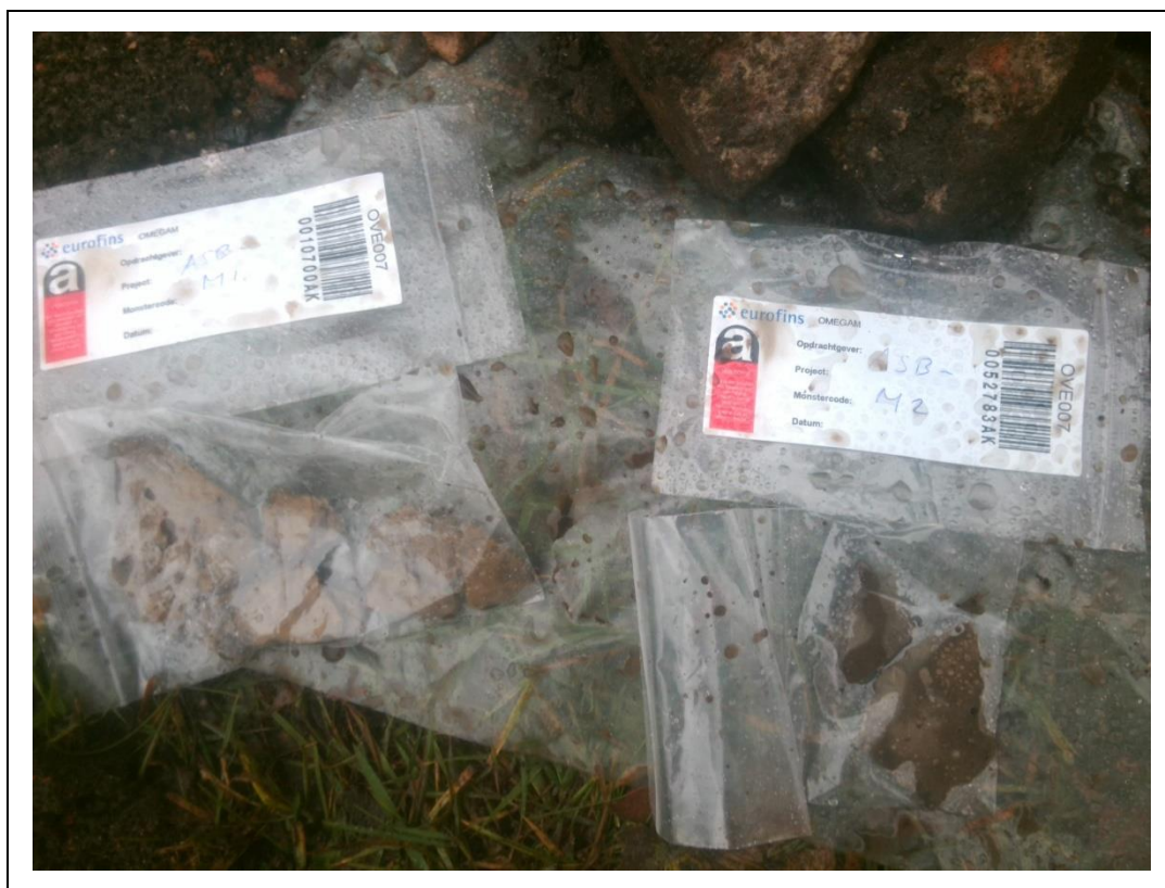
Foto 15. Asbestverdacht materiaal asbestinspectiegat B02
