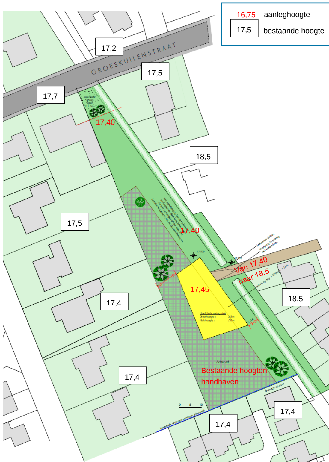
Figuur 3.5 Bestaande en aanleghoogtes Groeskuilenstraat Gemert
