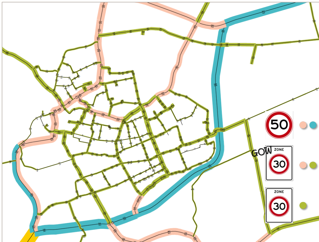
Figuur 4: plot referentie verkeersmodel voor het jaar 2030 met een categorisering naar snelheidsregime op basis van intensiteiten
