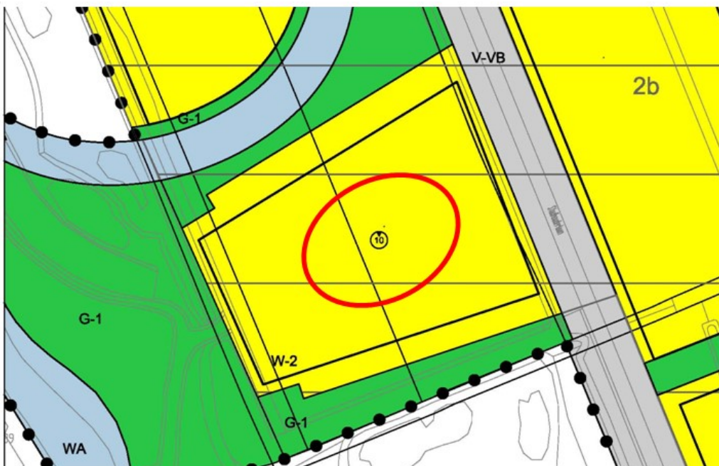
Afbeelding 4: opnemen maatvoering binnen bouwvlak: maximum bouwhoogte (10 meter)
